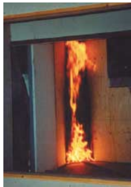
Träprodukt före och under provning i SBI (Single Burning Item), SS-EN 13823.
