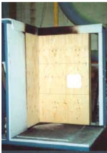
Träprodukt före och under provning i SBI (Single Burning Item), SS-EN 13823.
