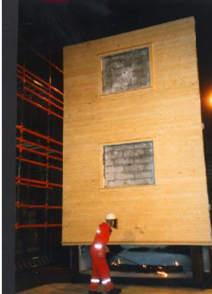
Brandskyddad träfasad före och efter fasadbrandprovning (SP Fire 105)
