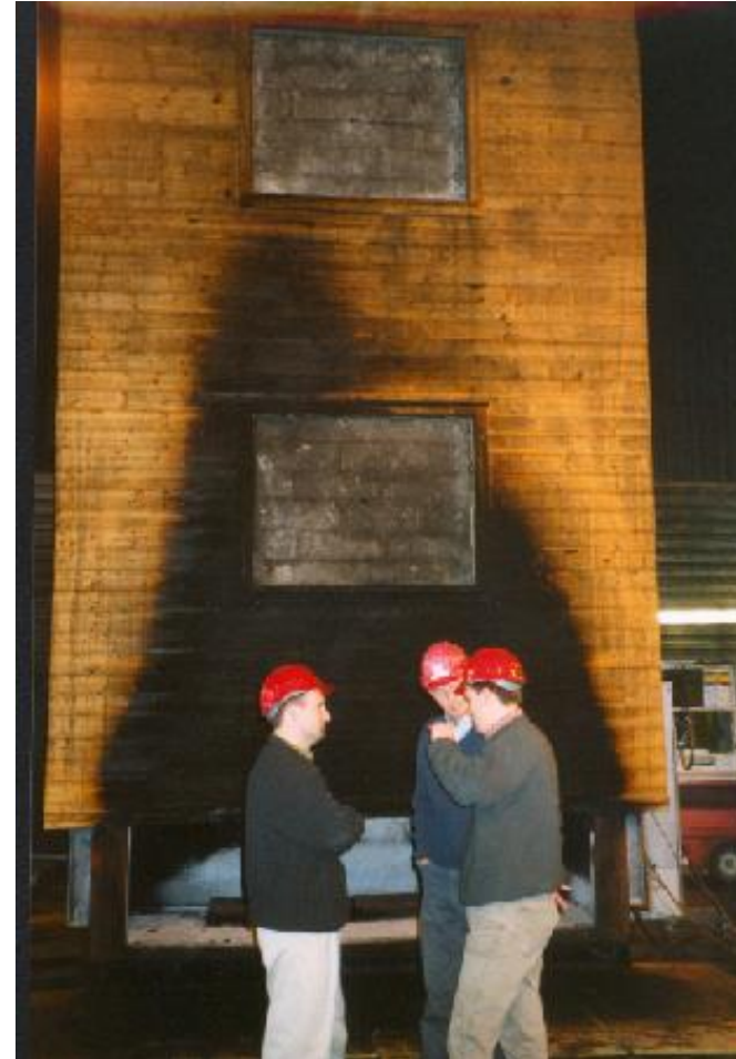
Brandskyddad träfasad före och efter fasadbrandprovning (SP Fire 105)
